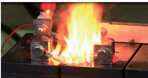
図3 大電流による発火状況
